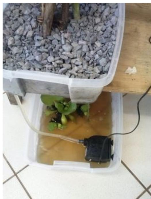
**Figura 3: Coloração do efluente após 24 horas de funcionamento do sistema piloto.**
